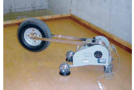
重量床衝撃音試験(バングマシン) 壁際 巾木納まり
